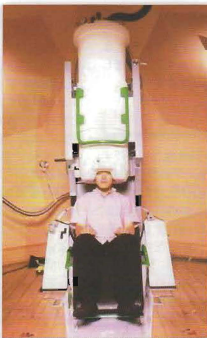
図 2. SQUID 型脳磁界計測装置。図 1 のシールドルーム内に設置されている。
