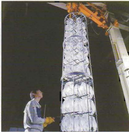
写真1 人工水晶のクレーン引き揚げ作業
