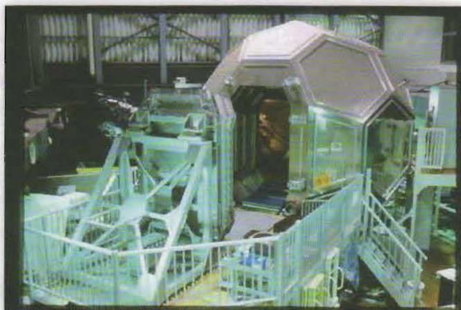
図1. 超高性能磁気シールドルーム。本学千葉キャンパス内の総合研究所千葉施設内に設置されている。（色調が少し変わっているのは、テレビドラマのロケに使われたときのものだからです。）
