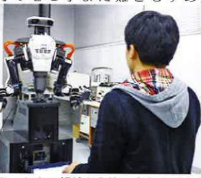
図3 ヒトの視線から注目点を予測するロボット
