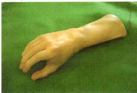
図5 TDU型マイコン搭載の電動義手
